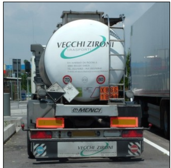
Figura 5.13: sezione cilindrica, quasi sempre in acciaio inox, con cisterna di dimensioni ridotte a causa del maggiore peso specifico della sostanza.
